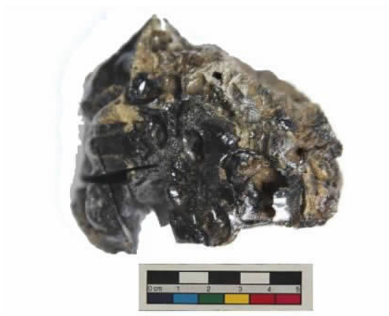
图一 东平陵故城冶铁遗址玻璃态炉渣 14003
