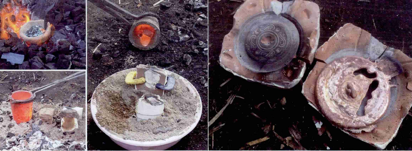
利用地炉进行冶炼和铸造实验
