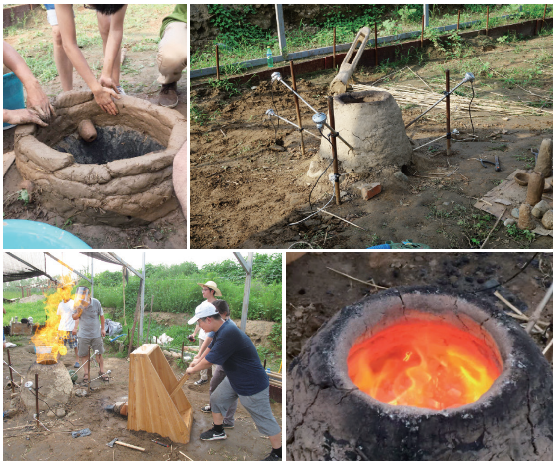
修筑的竖炉和利用竖炉冶炼场景
