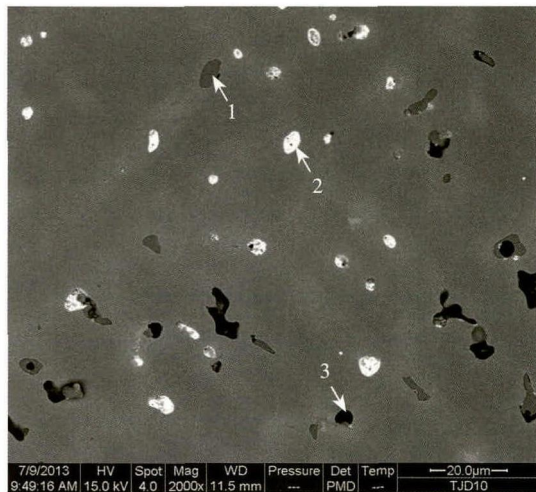
图一八 铜刻刀89T7⑦：11背散射电子像 (EDS微区分析：1、3. 夹杂物 2. 铅颗粒)
