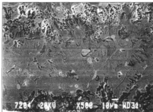
图五 7204 锈蚀层珠光体、夹杂物及磷共晶痕迹的二次电子像
