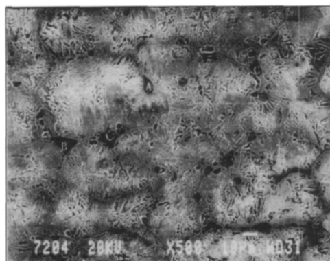
图四 7204 珠光体组织及硫化亚铁夹杂物的二次电子像
